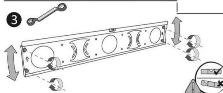
Verifique con el nivel burbuja que el soporte esté perfectamente derecho y ajuste los 4 tornillos tirafondo.
